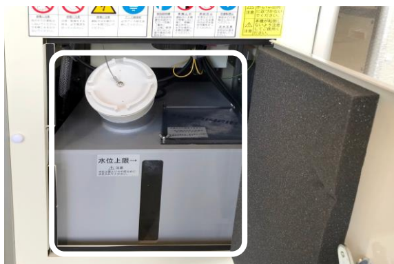
水タンク (背面扉内)
