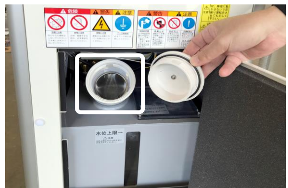
水タンク給水口
